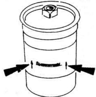
Рис. 2.138 НАПРАВЛЕНИЕ ПРОХОЖДЕНИЯ ТОПЛИВА В ФИЛЬТРЕ
